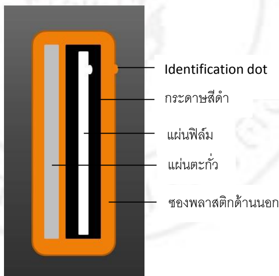
รูปที่ 7 ภาพวาดแสดงส่วนประกอบภายในช่องฟิล์มเอกซเรย์ชนิดที่ใช้ถ่ายในช่องปาก
